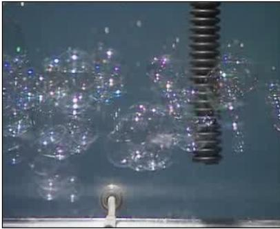
Dieses Experiment verdeutlicht, dass Gase und Dämpfe, die schwerer als Luft sind, in Bodennähe abgesaugt werden müssen. Die Dämpfe brennbarer Flüssigkeiten sind immer schwerer als Luft. Nur folgende Gase sind leichter als Luft, so dass sie oben abgesaugt werden müssen: Wasserstoff, Ethylen, Acetylen, Ammoniak, Blausäuregas, Kohlenmonoxid und Methan.
