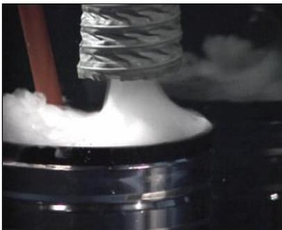
Durch eine örtliche Absaugung der Schadstoffe an der Entstehungsstelle kann die Ausbreitung im Raum weitgehend vermieden werden. Dieses Verfahren ist immer dann einzusetzen, wenn die Entstehungsstelle örtlich begrenzt ist (z.B. Abführen von Schweißrauchen).
