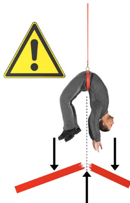
Abb. 32 Gefahr der Wirbelsäulenverletzung bei der Benutzung von Haltegurten zum Auffangen
