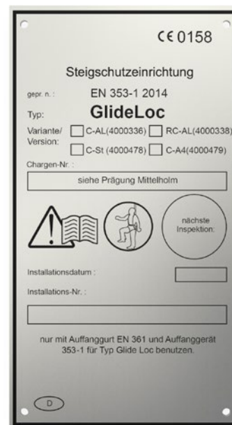
Abb. 45 Kennzeichnungsschild für die Führung (Typ GlideLoc)
