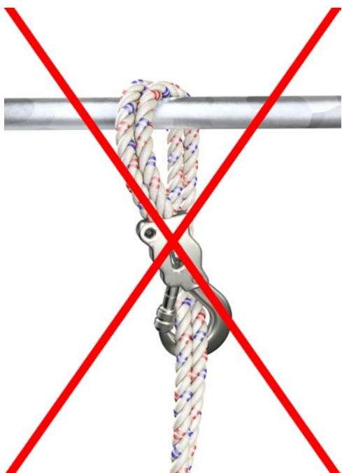
Abb. 79 Unsachgemäßes Anschlagen eines Reibungsfalldämpfers
