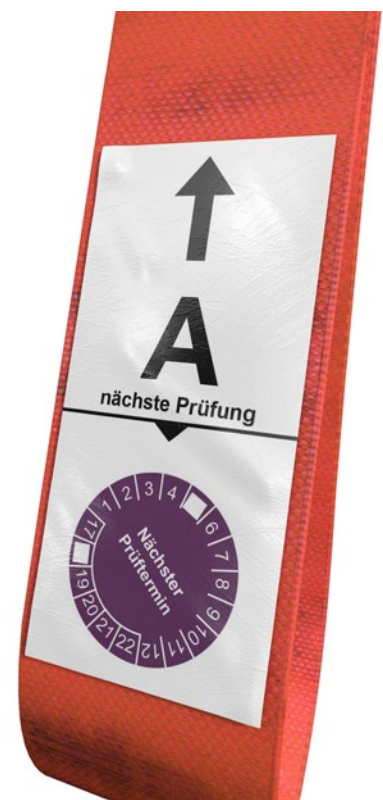
Abb. 81b Beispiel für eine Kennzeichnung mit Hinweis auf den nächsten Prüftermin
