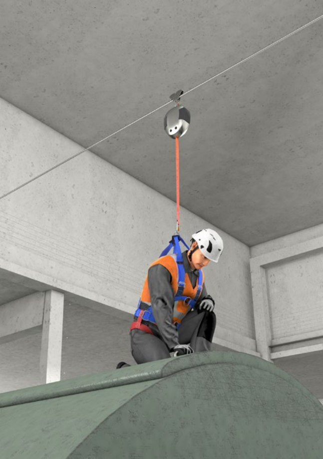
Abb. 70 Beispiel für eine dauerhaft befestigte Anschlageneinrichtung mit horizontalem Seil
