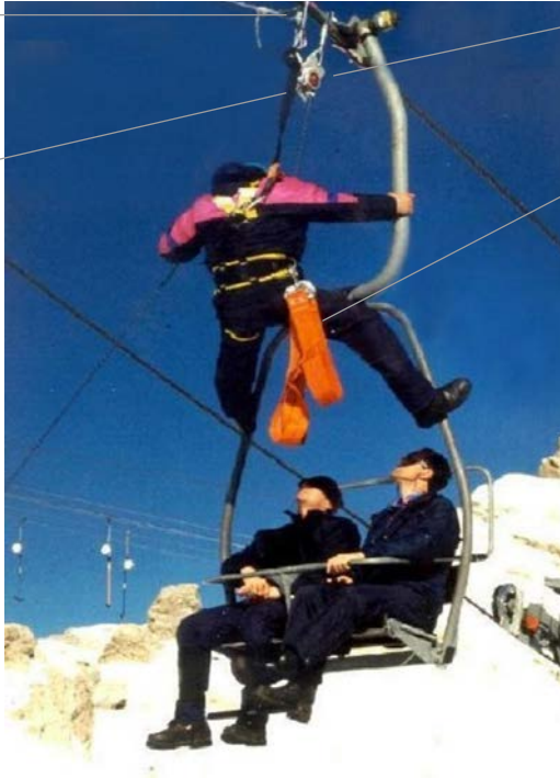
Abb. 24 Bergung aus einer Seilschwebbahn mittels Rettungsschleufe, Abseilgerät und Anschlagvorrichtung (Seilfahrgerät)
