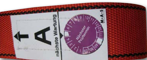
Abb. 27 Beispiel für die Dokumentation der Sachkundigenprüfung auf der Schutzausrüstung
