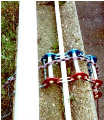
Abb. 26 Rollenbock als Kantenschutz für ein Verbindungsmittel aus einem Kernmantelseil
