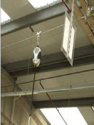
Abb. 16 Anschlagrichtung mit horizontalem Führungsseil
