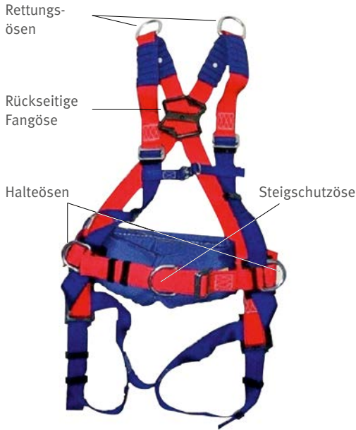
Abb. 2 Auffanggurt mit Rettungsösen (Dieser Gurt kann aufgrund der Ausstattung mit Auffang-, Steigschutz- und Halteösen auch als Auffang- und Haltegurt verwendet werden)
