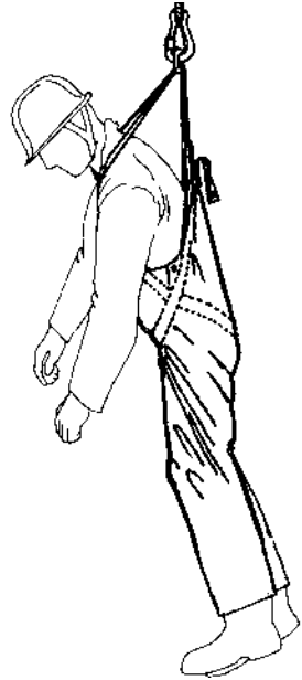
Abb. 3 Rettungsgurt in Arbeitshose eingearbeitet
