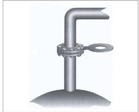
Abb. 18 Abtrennen mittels Steckscheibe
