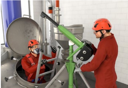
Abb. 22 Rettungswinde, hier als Schutz gegen Absturz eingesetzt
