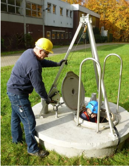
Abb. 27 Rettung mittels Hörsicherungsgerät mit Rettungshubfunktion
