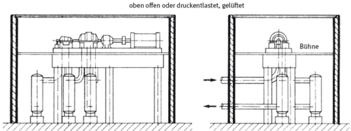
Abbildung 7: Beispiel einer Abschirmung für Sauerstoff-Turboverdichter
