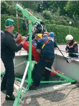
Abbildung 5: Mannloch mit Arbeitsbühne und installiertem Rettungsgerät
