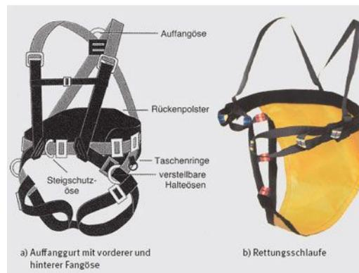
Rettungsschlaufen sind aufgrund ihrer einfachen Konstruktion und Anwendungsweise schnell und unkompliziert anzulegen und ermöglichen so eine schnelle Rettung.
