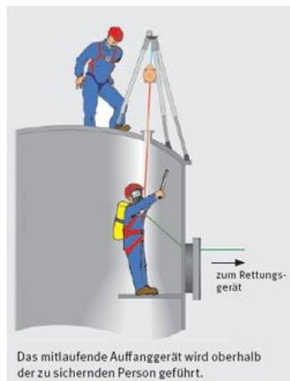
Abbildung 17: Mögliche Absturzsicherung mittels Höhensicherungsgerät
