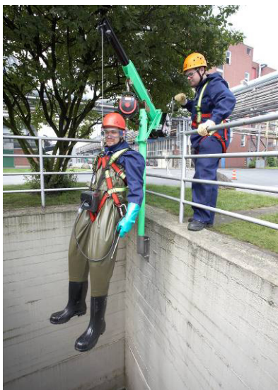
Einfahren in eine Abwassergrube mittels Rettungsgerät.
